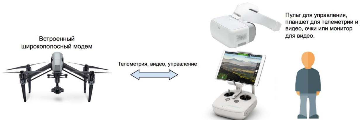
Рис. 2 Схема управления дронах посредством мобильных сетей
