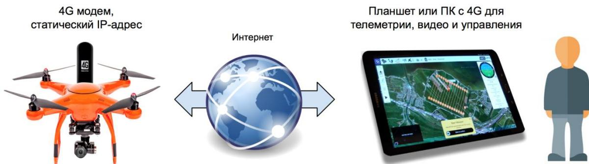
Рис. 3 Управлять дроном можно и через Интернет при наличии SIM карты со статическим IP-адресом
